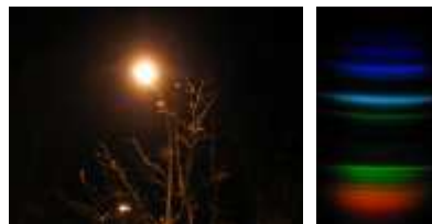
Farola de vapor de sodio, con espectro con líneas de emisión
