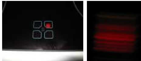
Indicador de una cocina vitrocerámica, con un espectro con líneas de emisión
